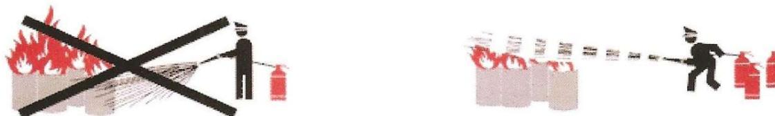
Olio e benzina accesi, situati in contenitori aperti, non vanno mai spenti usando l'estintore dall'alto, ma orientando il getto dell'estintore sul bordo del contenitore, cercando di rompere la fiamma per permettere il soffocamento dell'incendio.
